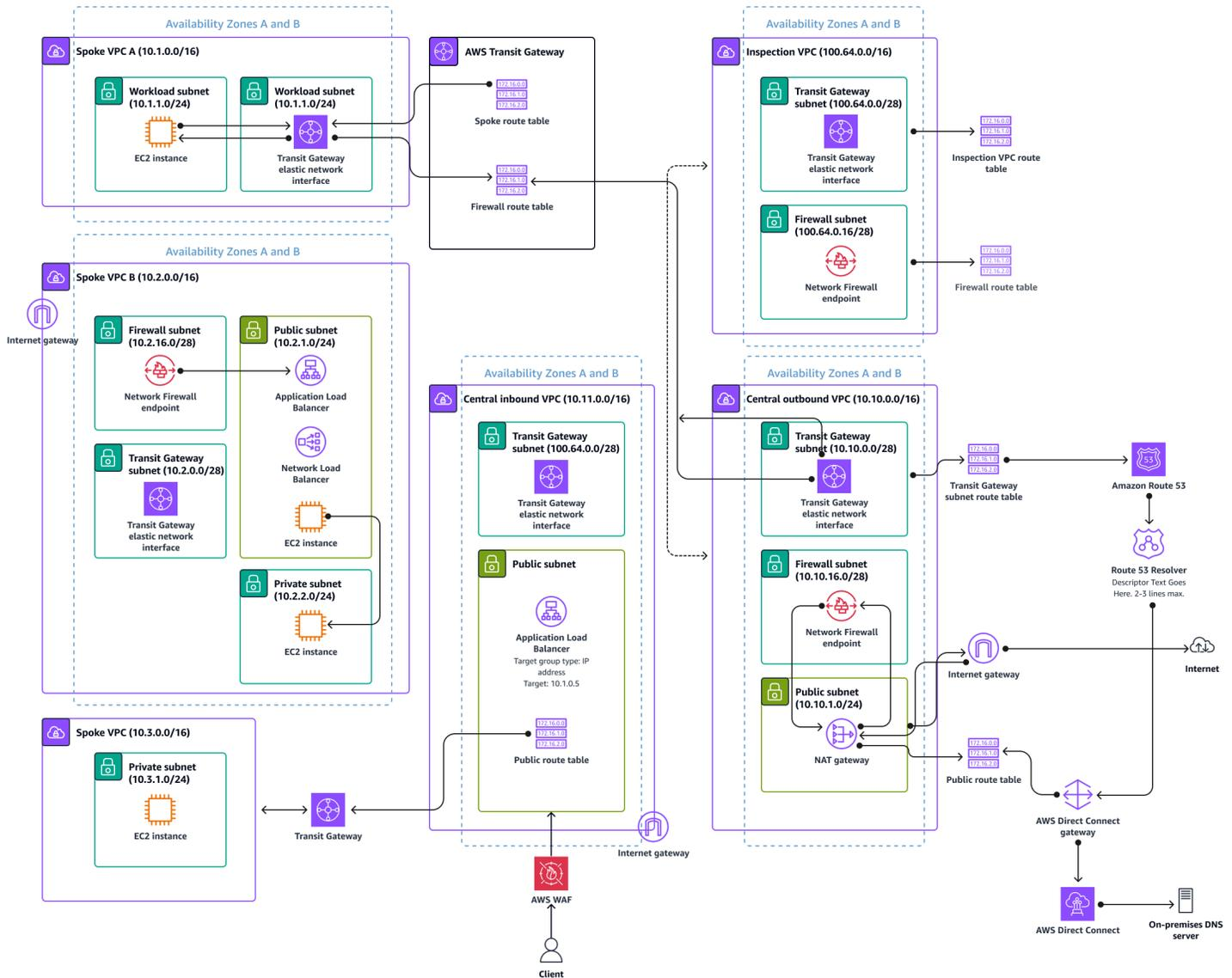
Der gesamte eingehende Datenverkehr, der zu den von der Organisation gehosteten Diensten kommt, wird durch AWS WAF und AWS Network Firewall bevor der Datenverkehr die Amazon Elastic Compute Cloud (Amazon EC2) -Instances erreicht, gefiltert. Der gesamte ausgehende Datenverkehr der Organisation wird zuerst von der Network Firewall gefiltert, bevor er das Ziel
