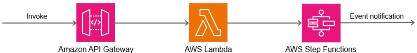
Cuando un cliente llama a la API, se invoca la función de Lambda y el preprocesamiento se realiza en la función de Lambda. La función inicia el flujo de trabajo de Step Functions para empezar a procesar la transacción distribuida. Si no es necesario preprocesar, puede [iniciar el flujo de trabajo de Step Functions directamente](#) desde API Gateway sin usar la función de Lambda.
