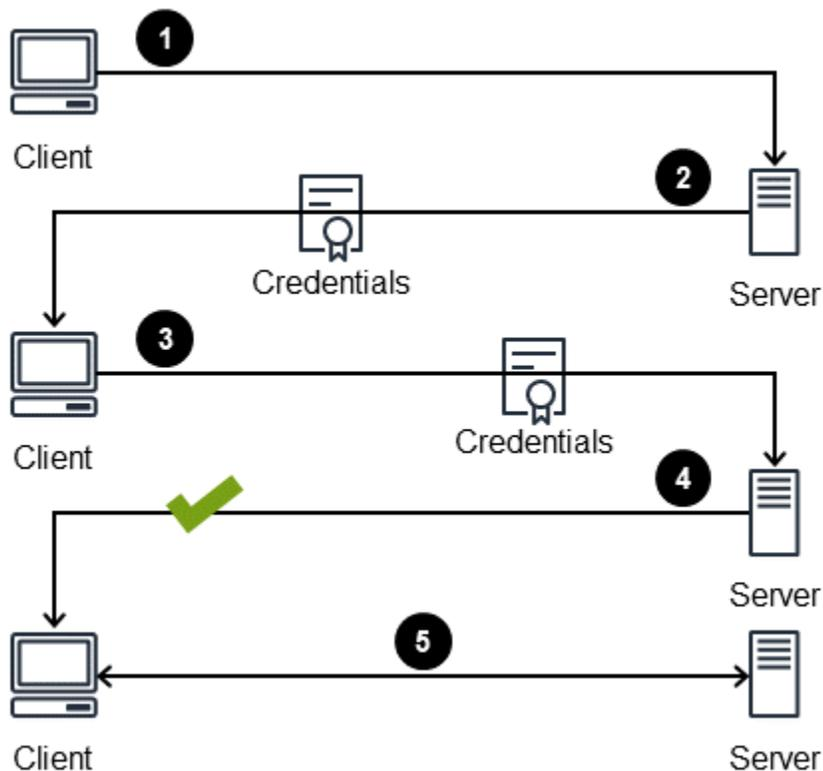
1. El cliente solicita una conexión TLS y muestra los conjuntos de cifrado compatibles.
