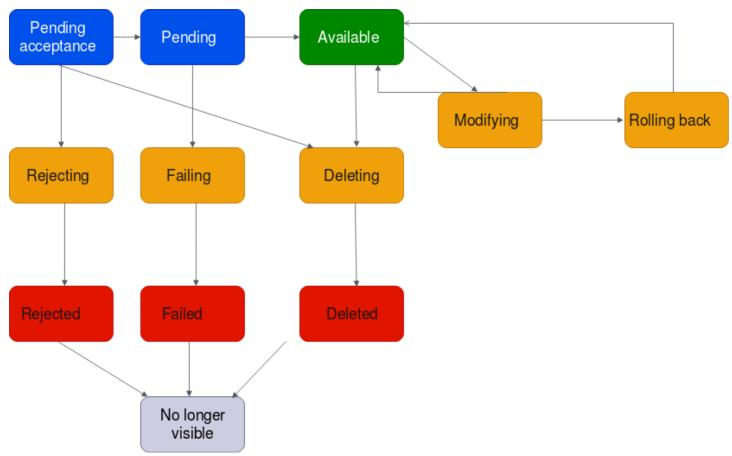
Aceptación pendiente: la solicitud de conexión de VPC está esperando la aceptación. En esta etapa, la conexión puede ir a pending, a rejecting o a deleting.
