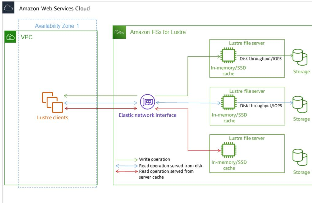
Ketika Anda membaca data yang disimpan di cache dalam-memori atau cache SSD pada server file, performa sistem file ditentukan oleh throughput jaringan. Ketika Anda menulis data ke sistem file Anda, atau ketika Anda membaca data yang tidak disimpan pada cache dalam memori, kinerja sistem file ditentukan oleh yang lebih rendah dari throughput jaringan dan throughput disk.
