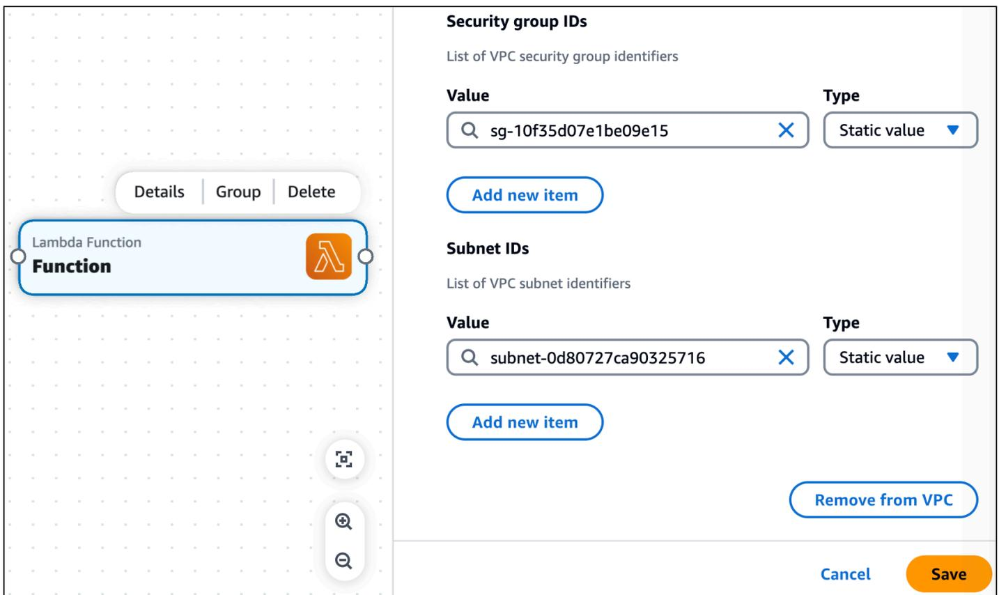
Ora che la nostra funzione Lambda è configurata con il nostro VPC, il tag VPC viene visualizzato sulla nostra scheda.
