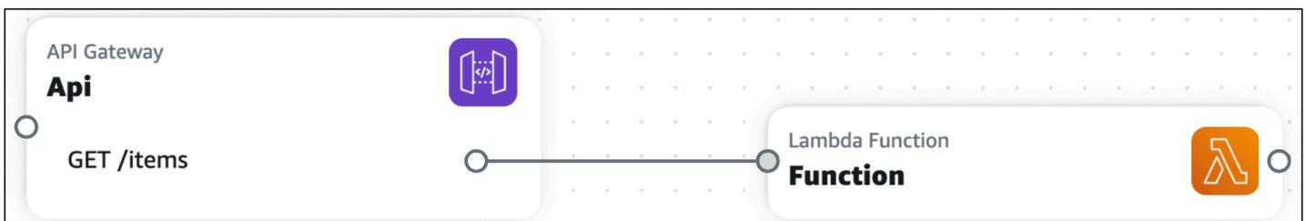
Come visto sopra, le linee tra le schede componenti avanzate sono solide. Al contrario, le schede di risorse IAC standard (chiamate anche schede componenti standard) non dispongono di porte di collegamento. Per queste schede, è necessario specificare queste relazioni basate sugli eventi nel modello dell'applicazione e Infrastructure Composer rileverà automaticamente le relative connessioni e le visualizzerà con una linea tratteggiata tra le schede.
