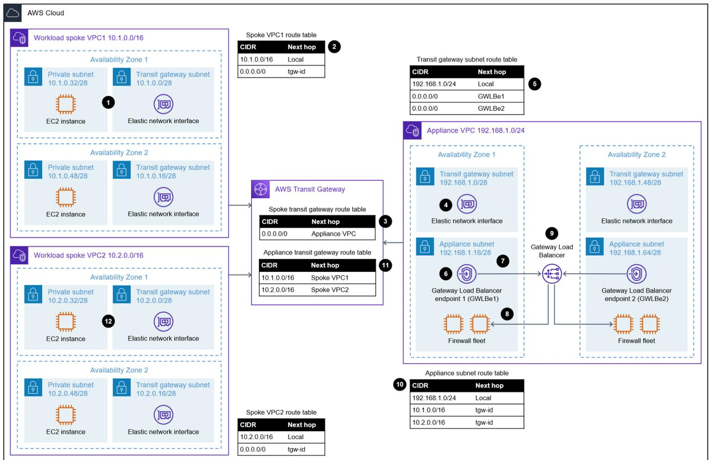
In questo caso d'uso, i due VPC spoke ospitano le istanze EC2 del carico di lavoro in due zone di disponibilità e un VPC di appliance ospita i dispositivi firewall di terze parti per l'ispezione del traffico. I VPC sono collegati tra loro tramite AWS Transit Gateway. Il diagramma mostra il seguente flusso di pacchetti quando un'istanza EC2 in `Workload spoke VPC1` nella zona di disponibilità 1 invia un pacchetto a un'istanza in `Workload spoke VPC2` nella zona di disponibilità 1:
