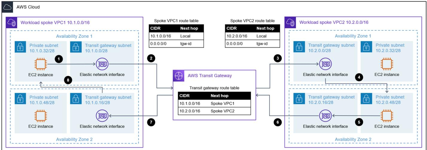
Il diagramma mostra il flusso di traffico quando un'istanza Amazon Elastic Compute Cloud (Amazon EC2) di origine Workload spoke VPC 1 nella zona di disponibilità 1 invia traffico tramite Transit Gateway a un'istanza EC2 di destinazione Workload spoke VPC2 nella zona di disponibilità 2:
