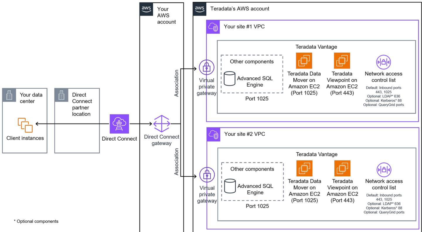
Per creare un'architettura basata sul diagramma precedente, devi creare un gateway Direct Connect nel tuo account AWS e chiudere l'interfaccia virtuale privata (VIF) al gateway Direct Connect. Dovrai quindi accettare la proposta di associazione per il gateway privato virtuale sull'account Teradata AWS.
