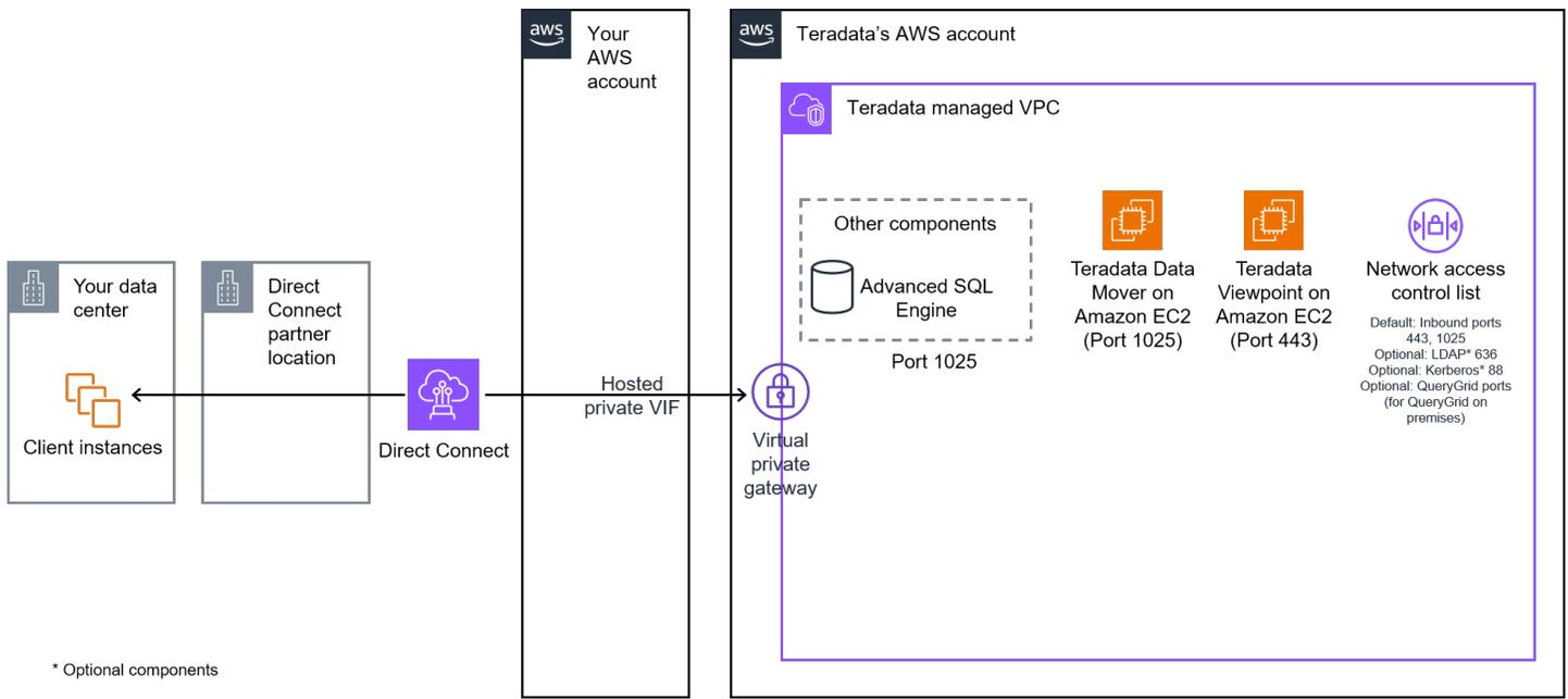
Per creare un'architettura basata sul diagramma precedente, è necessario creare un VIF privato ospitato e condividerlo con Teradata Enterprise per stabilire la connettività. VantageCloud Un VIF privato è un'interfaccia di rete che consente di utilizzare Direct Connect per connettersi a un altro account AWS, ad esempio un account Teradata Enterprise VantageCloud AWS. Le tariffe di uscita dalla rete si applicano ai servizi privati. VIFs
