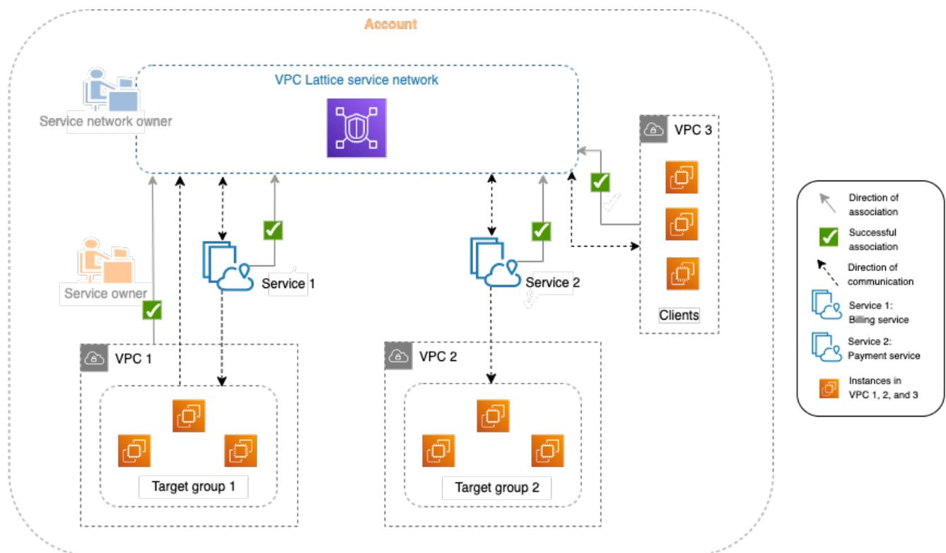
Il servizio 1 è un'applicazione di fatturazione in esecuzione su un gruppo di istanze registrate con il gruppo target 1 in VPC 1. Service 2 è un'applicazione di pagamento in esecuzione su un gruppo di istanze registrate con il gruppo target 2 in VPC 2. VPC 3 si trova nello stesso account e dispone di client ma non di servizi.
