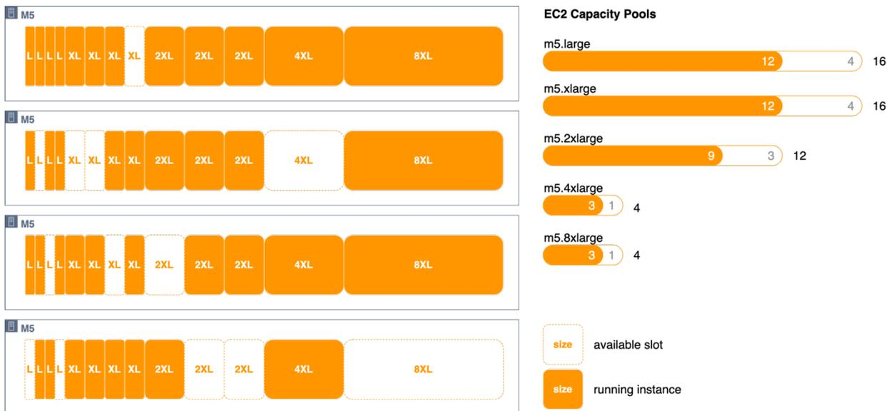
Visualizzazione degli slot dei server EC2, delle istanze in esecuzione e dei pool di slot
