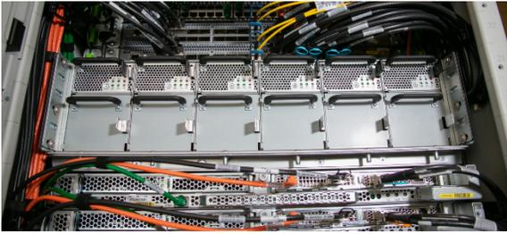
Figura 3 - Alimentatori AWS Outposts AC-DC e distribuzione dell'alimentazione tramite bus bar
