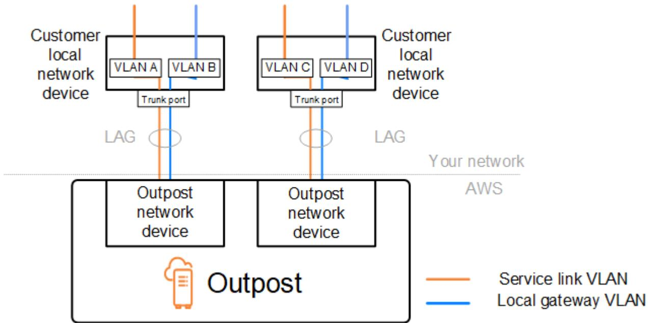
설치 및 운영 중에 Outpost를 온프레미스 네트워크와 통합하려면 Outpost 네트워크 장치와 고객 로컬 네트워크 장치 간에 사용되는 VLAN을 할당해야 합니다. 설치 AWS 전에이 정보에 제공해야 합니다. 자세한 내용은 [the section called “네트워크 준비 체크리스트”](#) 단원을 참조하십시오.
