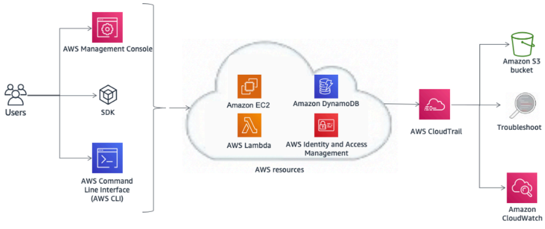
그림 2 – AWS CloudTrail을 사용한 규정 준수 감사 및 보안 분석을 위한 아키텍처의 예
