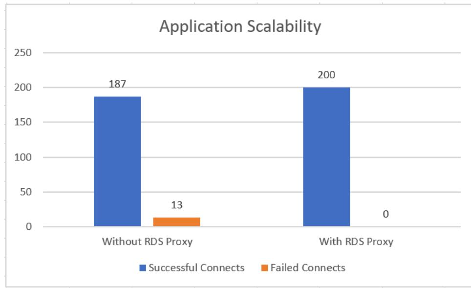
因为 RDS 代理使用连接池，所以即使数据库实例的并发连接上限为 187 个，使用 RDS 代理端点的测试应用程序也能够扩展到 20,000 个客户端连接。
