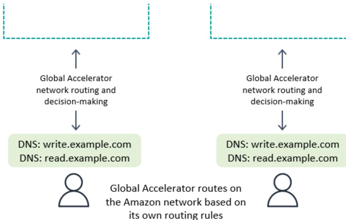
通过写入任何区域模式，或者与后端的计算层请求路由结合使用，Global Accelerator 可以无缝运行。客户端连接到最近的边缘站点，不必担心哪个区域会收到请求。
