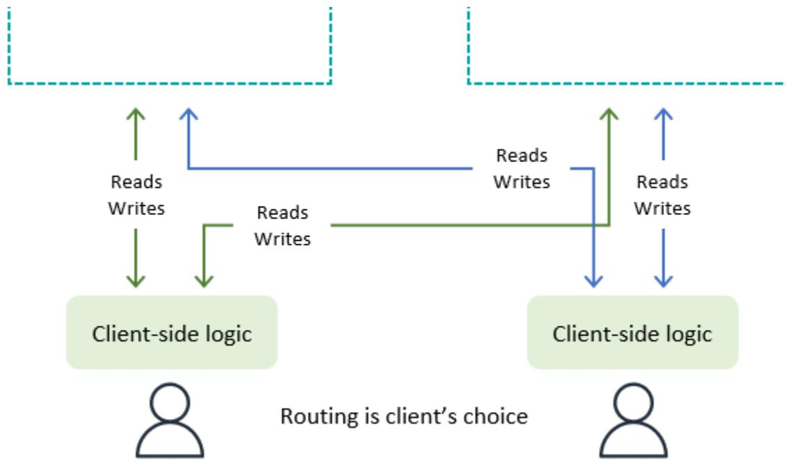
作为一项优势，客户端驱动的请求路由可以适应诸如现实世界的公共互联网流量状况之类的因素，以便在发现任何性能下降时切换区域。客户端必须知道所有潜在的端点，但启动新的区域端点并不常见。
