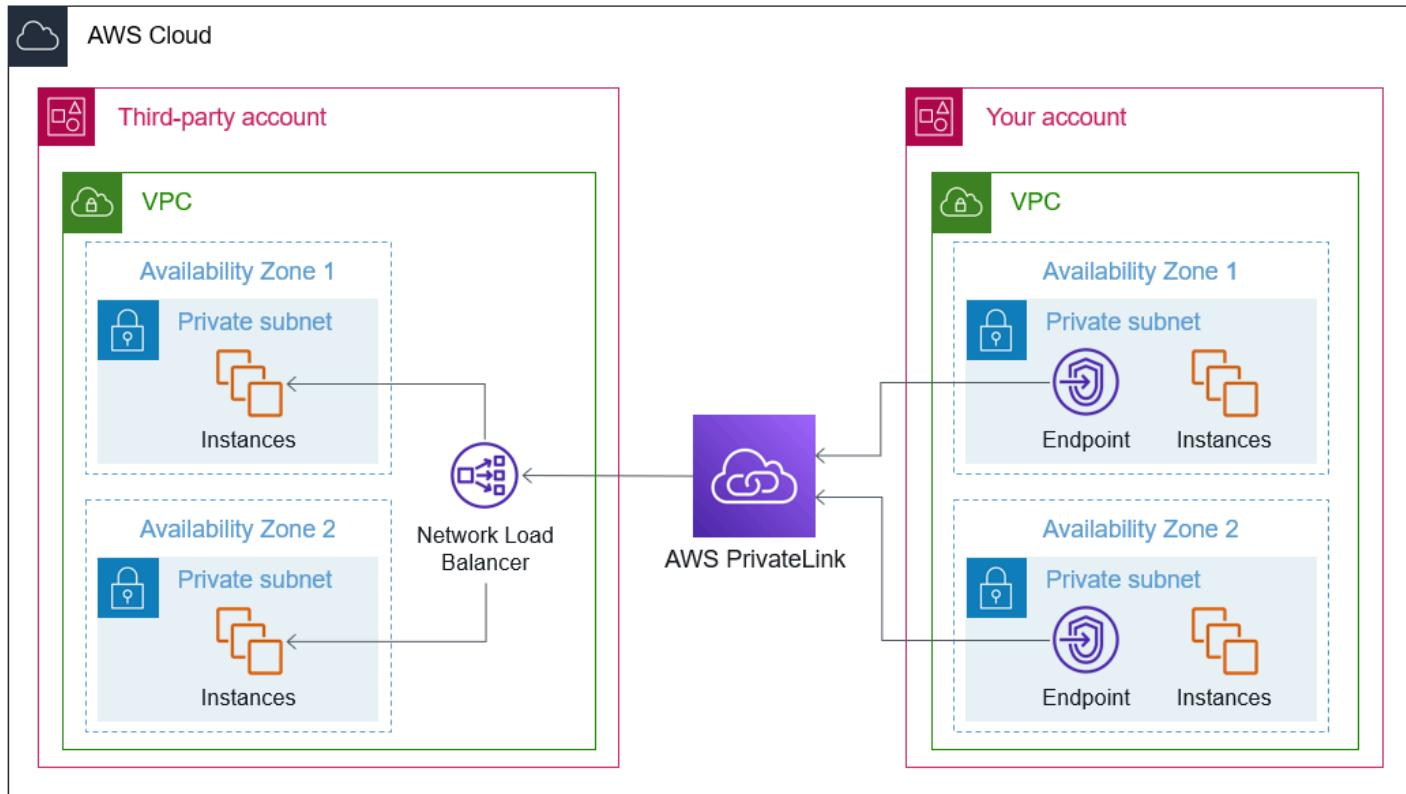
这种架构是集成第三方服务最常用的方法，因为它在第三方账户和您的账户之间提供了强大的隔离，且无需共享组件。它允许重叠 CIDR 块，这是与外部账户集成时最突出的挑战之一。它还抽象了网络通信路径。但它仅限于 TCP 流量和单向通信。第三方工作负载无法向您的账户发起通信。
