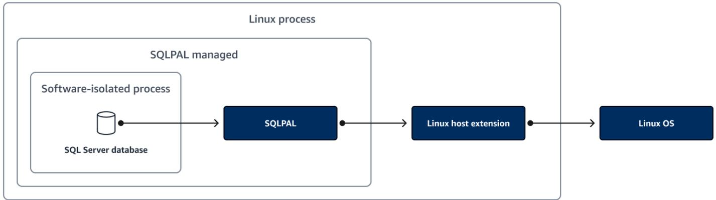
SQLPAL 负责抽象 SQL Server 和底层操作系统之间的调用和通信。主机扩展只是一个原生 Linux 应用程序。低级操作系统函数是用于优化 I/O、内存和 CPU 使用率的本机调用。当主机扩展启动时，它会加载并初始化 SQLPAL，然后启动 SQL Server。SQLPAL 启动独立的软件进程，为其余代码提供所需的翻译。在 SQL Server 架构中添加这一新层意味着，无论使用哪种操作系统，都可以使用使 SQL Server 在 Windows 上如此强大的企业级核心功能和优势。
