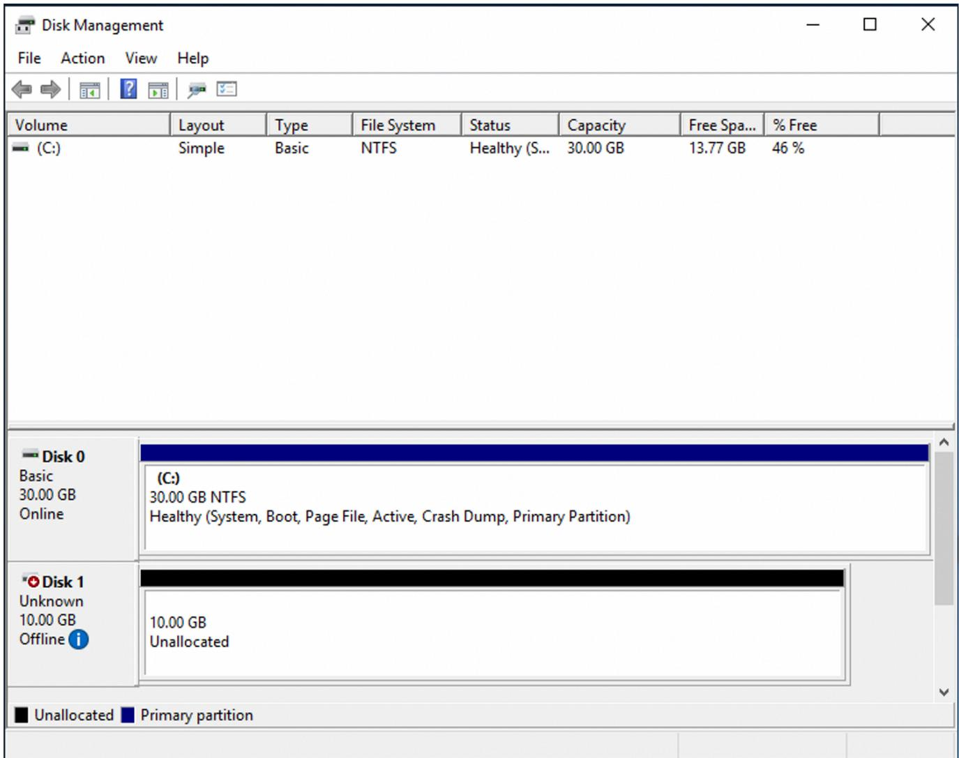
4. 找出未配置的磁碟這是 iSCSI LUN。在此範例中，磁碟 1 是 iSCSI 磁碟。它處於離線狀態。
