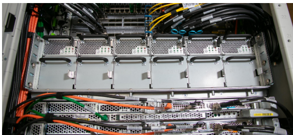
圖 3-交 AWS Outposts 流對直流電源供應器和匯流排條配電
